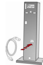
Figura 3 - Instalação do cabo de força ao equipamento
